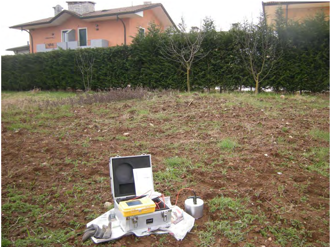
Foto 5: Esecuzione dell'Indagine Sismica Passiva con tecnica "HVSr" Sensore sismico 3D frequenza 2Hz e Sismografo digitale Vibralog a 24 bit (M.A.E.)
