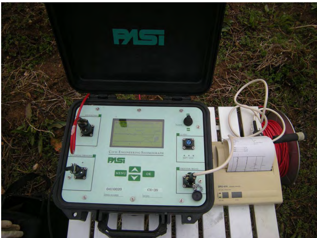
Foto 4: sismografo a 3 canali della ditta PASI, modello LCM-3
