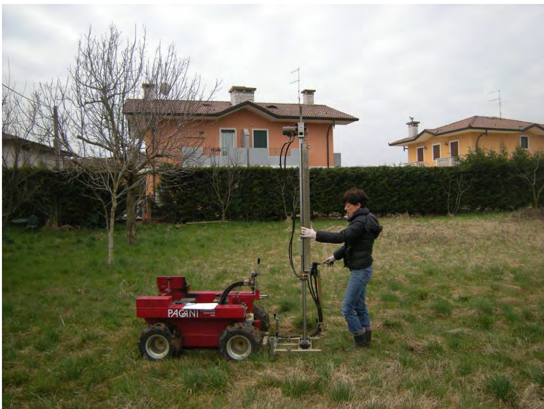
Foto 2: Esecuzione della prova penetrometrica n°2
